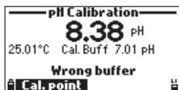
"Puffer falsch" wird angezeigt, wenn der pH-Messwert zu weit vom gewählten Pufferwert entfernt ist. Dies tritt häufig unmittelbar nach Abschluss einer Pufferkalibrierung auf, aber bevor der pH-Sensor zum nächsten Puffer bewegt wurde. Prüfen Sie, ob der richtige Kalibrierpuffer ausgewählt wurde.
