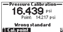
"Standard falsch" wird angezeigt, wenn der Wert für den atmosphärischen Druck außerhalb des zulässigen Bereichs liegt.
