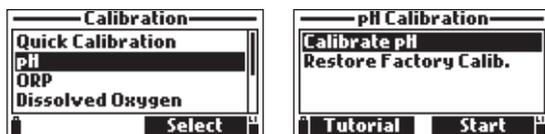
**Kalibriere pH:** Sie können eine neue Kalibrierung mit bis zu 3 Puffern durchführen (pH 4,01, 6,86, 7,01, 9,18, 10,01 oder ein benutzerdefinierter Puffer). Wenn eine Dreipunktkalibrierung durchgeführt wird, überschreiben die neuen Daten die alten. Bei einer Ein- oder Zweipunkt-Kalibrierung verwendet das Messgerät auch Informationen aus der vorherigen Kalibrierung, falls vorhanden.
