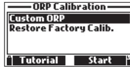
Redox benutzerdefiniert: Sie können eine Einzelpunktkalibrierung unter Verwendung eines benutzerdefinierten Punktes durchführen.
