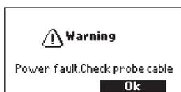
"Fehler mit Stromvers. Kabel überprüfen." wird angezeigt, wenn das Messgerät mit einer angeschlossenen Sonde eingeschaltet wird, aber diese nicht mit Strom versorgt wird. Z.B. wird dies durch eine hohe Last am Sondenanschluss ausgelöst.
