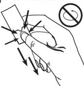
2. Entfernen Sie den verbrauchten O-Ring, indem Sie ihn vom Sensor abrollen.
