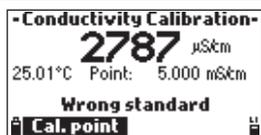
"Standard falsch" wird angezeigt, wenn der Wert für die Leitfähigkeit außerhalb des zulässigen Bereichs liegt.
