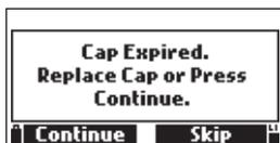
"Cap Expired" wird angezeigt, wenn die Haltbarkeit der Kappe des opdo-Sensors abgelaufen ist.
