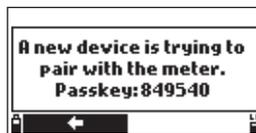
1. Geben Sie das Kennwort ein, um die Kopplung zuzulassen. Das Kennwort wird für zukünftige Verbindungen oder bis zum Löschen der gekoppelten Geräte gespeichert (siehe "9. SYSTEM-SETUP").
