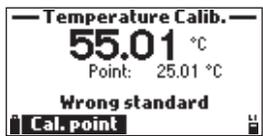
"Standard falsch" wird angezeigt, wenn der Wert für die Temperatur außerhalb des zulässigen Bereichs liegt.
