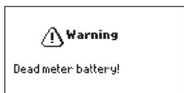
Die Anzeige 'Batt. leer (Meter)!' erscheint, wenn die Batterien des Messgeräts zu schwach sind, um das Messgerät zu betreiben. Das Messgerät schaltet sich automatisch aus.
