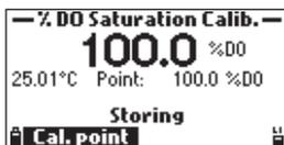
6. Um bei 0 % zu kalibrieren, füllen Sie den Kalibrierbecher zu 2/3 mit der Nullsauerstofflösung [HI7040](#).
