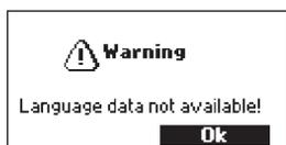
"Sprachdaten nicht verfügbar!" wird beim Einschalten des Messgeräts angezeigt, wenn die Sprachdatei nicht geladen werden kann.
