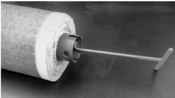
Bei Bedarf\*, oder wenn die Rolle voll ist, nehmen Sie das verbrauchte Vlies aus dem Filter. Haken Sie mit dem beigefügten Werkzeug in eine der Bohrungen ein und ziehen Sie die zwei Teile der Hülse jeweils seitlich aus der verbrauchten Vliesrolle heraus.
