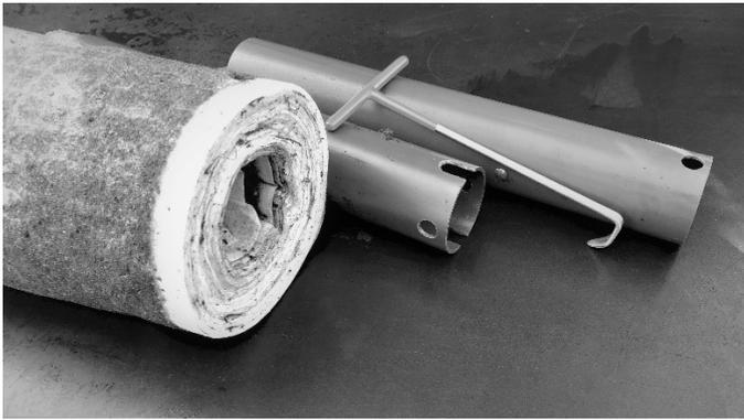
Die Wickelhülse ist nun wieder für eine neue Rolle Vlies einsatzbereit.
