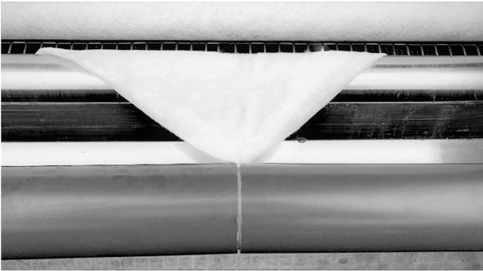
Ziehen Sie das neue Vlies wie gewohnt in den Filter ein. Schneiden oder falzen Sie die das neue Vlies V-förmig zu und drehen Sie die Spitze zusammen. Ziehen Sie die Hülse etwas auseinander und fädeln Sie die Spitze in die Aussparung der Hülse ein.
