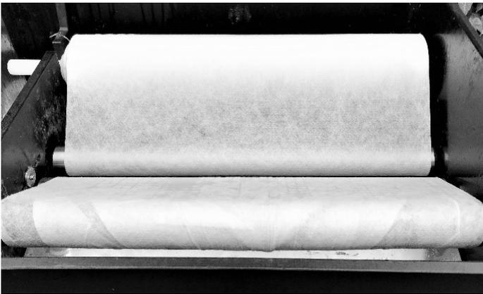
Um ein späteres Herausziehen der Hülse deutlich zu vereinfachen, oder um eine Adhäsion bei langen Filterstandzeiten zu vermeiden, können Sie die Hülse auch zusätzlich mit dem beiliegenden Gleitmittel einstreichen. Drehen Sie danach das Vlies einige Umdrehungen auf, um es mit der Hülse zu verbinden.
